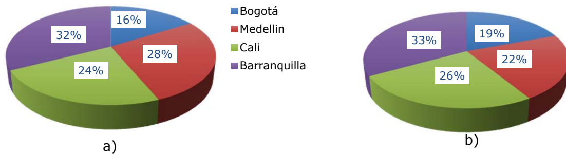
Fig. 5. Comportamiento del consumo de energía de uso final en el edificio de oficinas para clima Bogotá (frío), Medellín (templado), Cali (cálido-seco) y Barranquilla (cálido-húmedo). Siendo, a) sistema de climatización a volumen de aire constante con unidades terminales tipo Fan Coil (FC) y b) sistema centralizado a volumen de aire variable (VAV).
