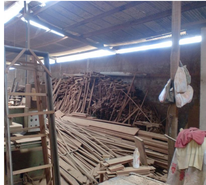
Fig.2: disposição inadequada de madeira para reuso
