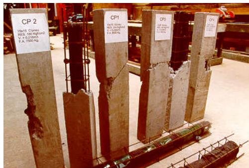
Fig. 1 – Vigas de baldrame pré-moldadas com pneus em canudo
