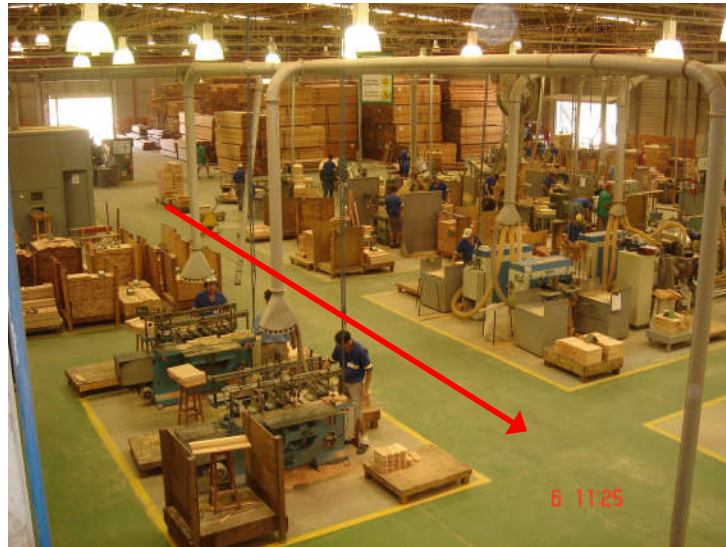
Fig.2: novo parque fabril (literalmente uma linha de produção), sistemas de sucção e circulação visível.
