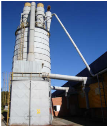
Fig. 4: Silos que recebem o cavaco.
