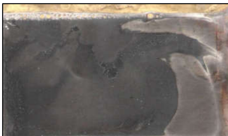
Figura 1. Fotografia da placa de latão (cátodo), onde foi realizada a eletrodeposição de \text{Ni}^0 proveniente do \text{NiSO}_4 \cdot x\text{H}_2\text{O} (amostra), pelo ensaio da célula de Hull.
