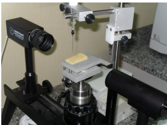
Fig. 1 - Amostra de lã de vidro disposta no goniômetro para análise.
