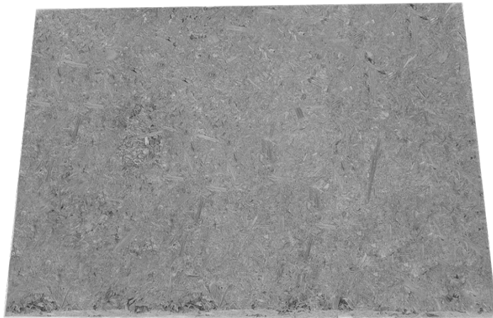
Fig. 1. Chapa recomposta de bambu fabricada com adesivo PVA. Adaptado de Kravchenko (2012)
