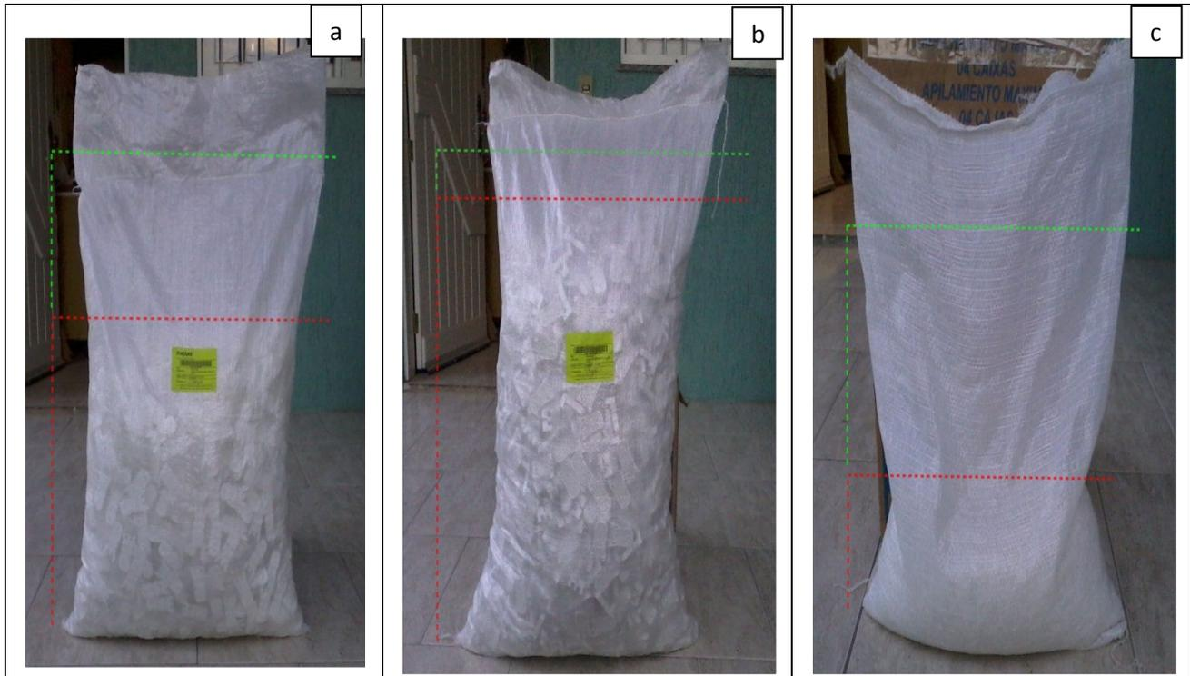
**Fig. 4.** Percentual de utiliza  o das embalagens. (a) Embalagem de tampa soquete (2500 pe as ocupando 48% da capacidade).(b) Embalagem de caixa soquete (2500 pe as ocupando 65% da capacidade).(c) Embalagem de mola soquete (10000 pe as ocupando 17% da capacidade).
