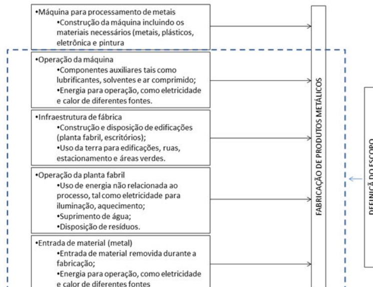
Fig. 2. Diagrama representando a estrutura de processos e seleção do escopo para o inventário da fabricação de produtos metálicos (Fonte: Ecoinvent MetalsProcessingandCompressed Air Supply – Data v2.0, 2007)
