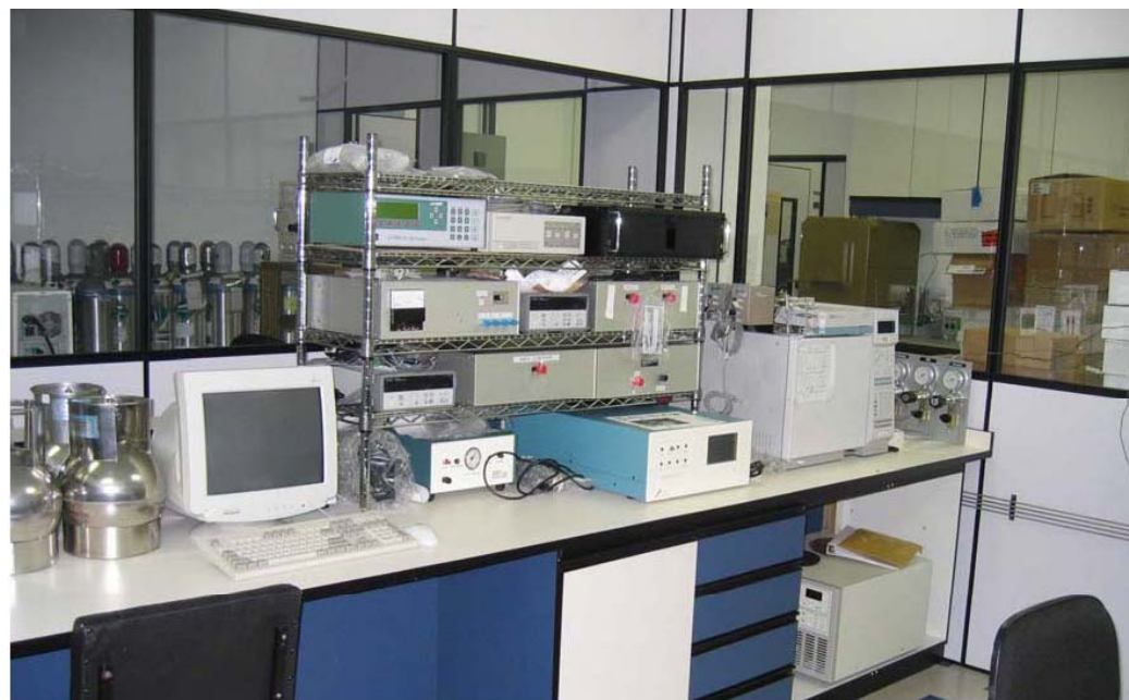
Fig. 3- Sistema MAGICC 3/Brasil – Sistema de análise de Gases de Efeito Estufa no LQA/IPEN.
