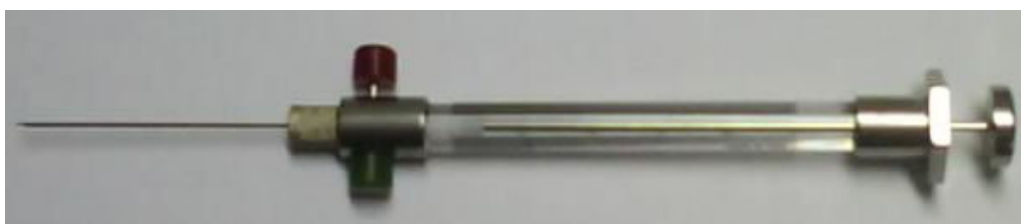
Fig.3: Seringa cromatográfica gastight para retirada de amostras de gases da decomposição dos pesticidas.
