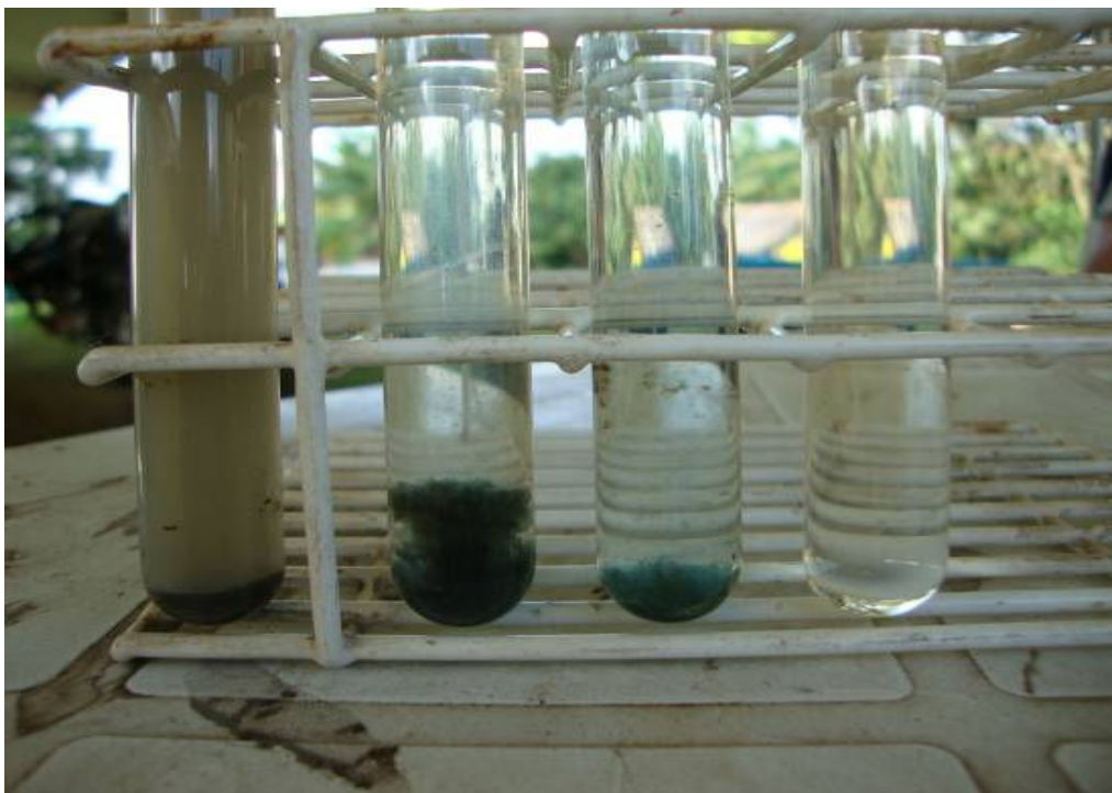
Fig. 1: Amostras dos efluentes coletados durante o tratamento com eletrólise sendo, da esquerda para a direita: o efluente inicial coletado do tanque de lavagem; o efluente após 10 minutos de tratamento; após 20 minutos e após 30 minutos.
