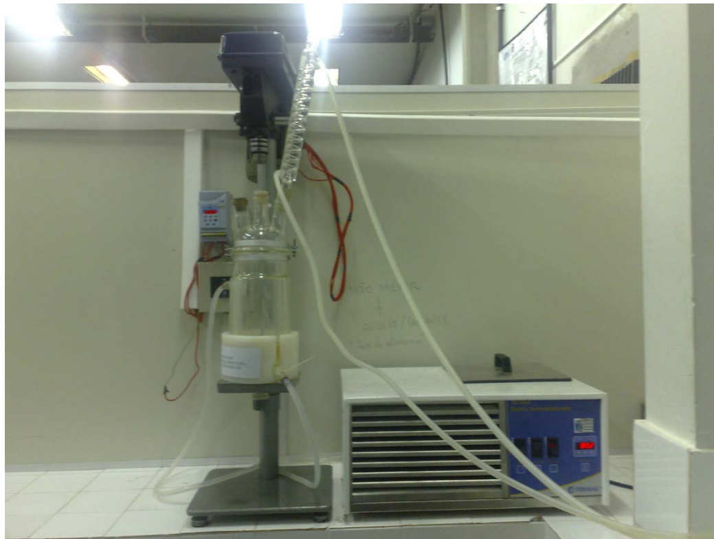
Figura 3. Equipamento para reação de produção de biodiesel devidamente montado.
