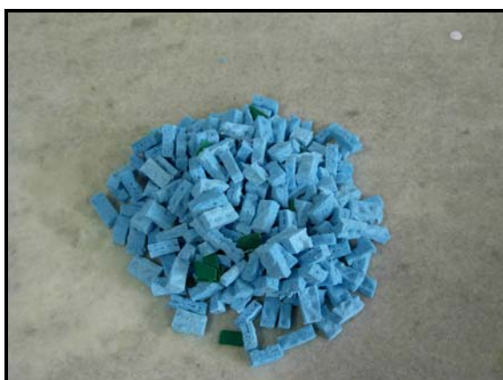
Fig. 2 Resíduos da bioespuma poliuretana com pedaços de tecido de algodão
