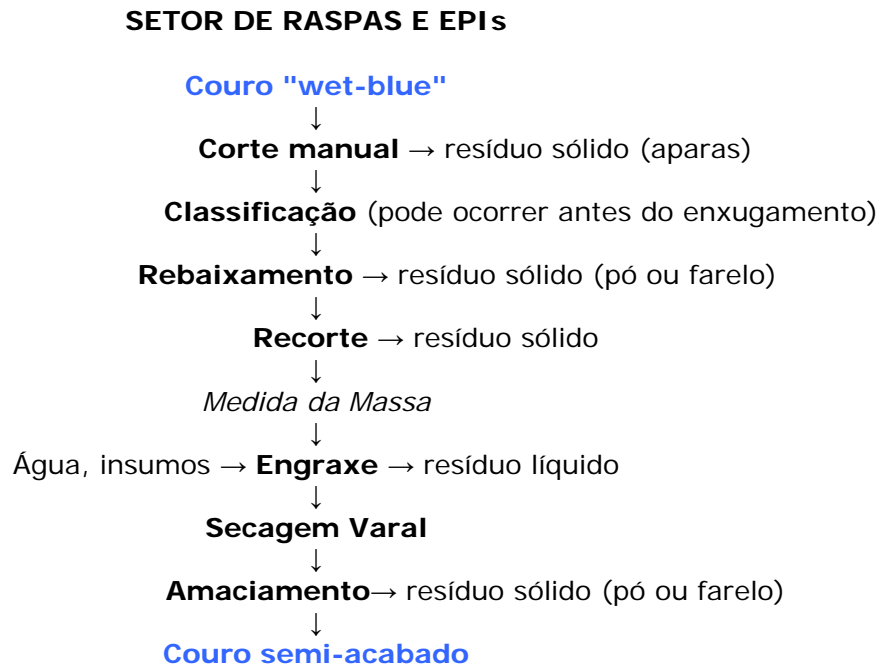
FIGURA 2: Fluxograma do processo no setor de raspas de couro
