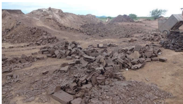
Fig. 3. Reutilização de blocos crus defeituosos no processo de estocagem da argila.
