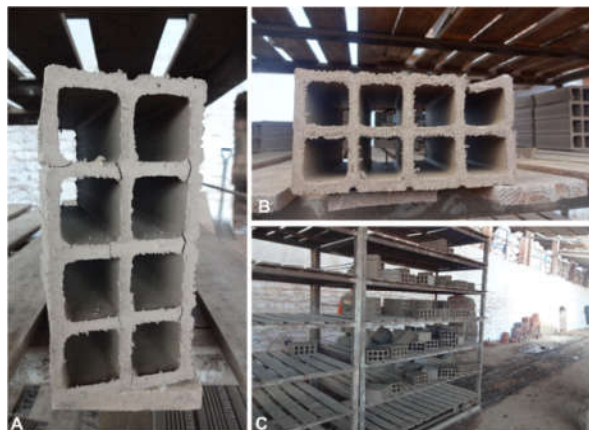
Fig. 2. Bloco cru seco trincado (A), bloco cru seco deformado (B) e blocos crus secos com essas não conformidades sendo transportados para serem reutilizados na estocagem de argila.
