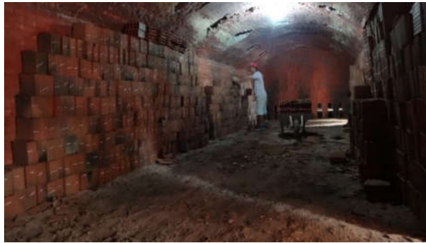
Fig. 6. Produtos defeituosos gerados no processo de queima.
