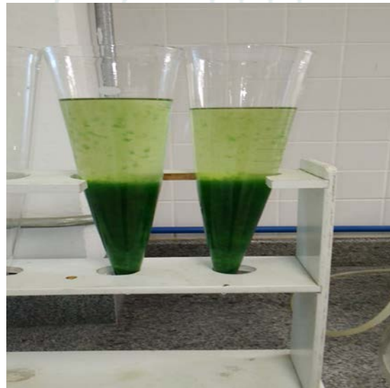
Microalga Chlorella sp decantando nos cones de Imhoff
