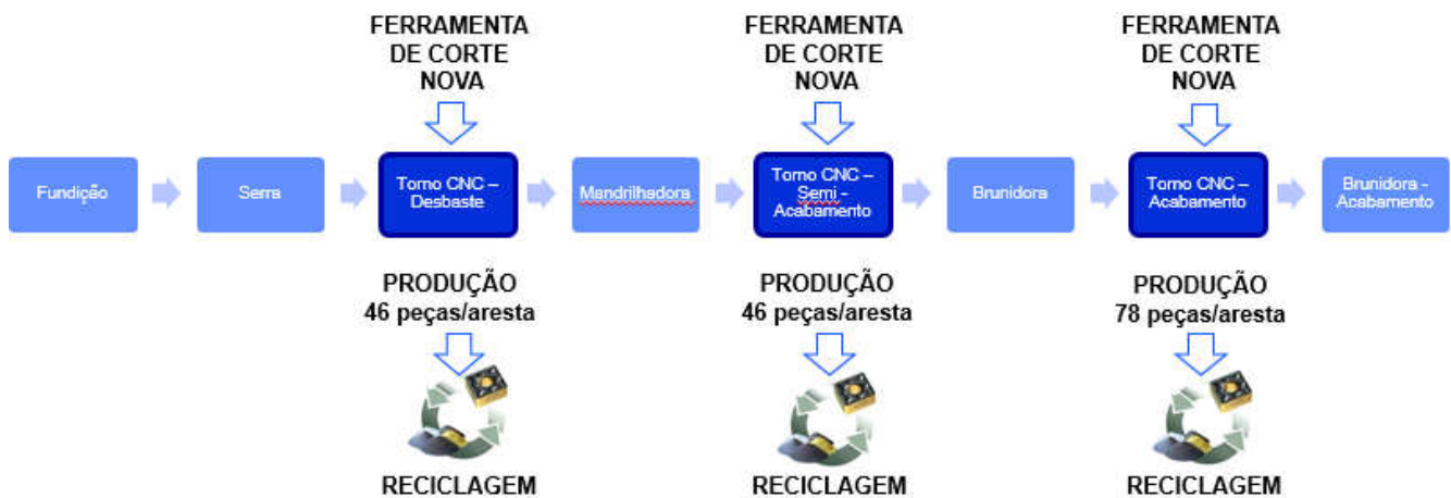
Fig.4: Linha de Usinagem das Camisas– Baseada na Economia Linear (Fonte: Autor).
