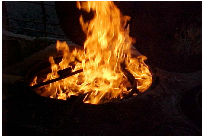
Fig. 5 Combustión de briquetas tubulares en cámara de combustión semiabierta con revestimiento térmico.
