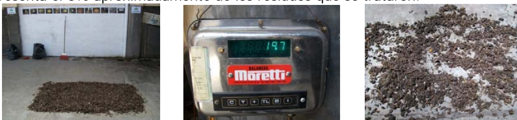
Imagen 15: Reducción final del Volumen (Izq), Peso seco total 19,7 Kg. (centro) y color homogéneo (Der.)
