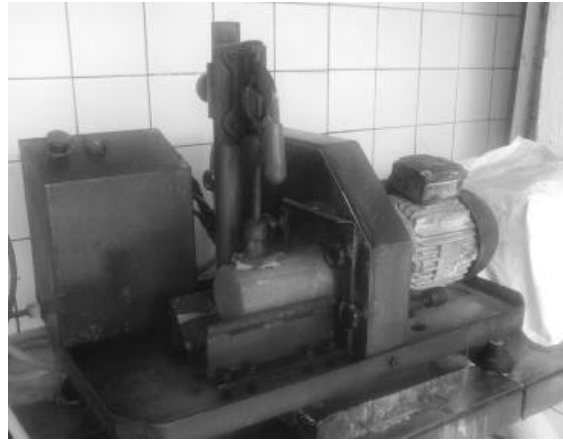
Fig. 2 – Faceamento do corpo-de-prova
