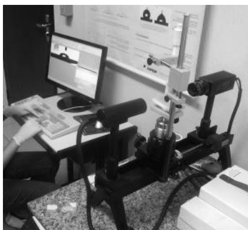
Fig. 1 – Goniômetro utilizado nos ensaios de molhabilidade
