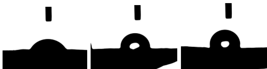
Fig. 4, 5 e 6 – Forma da gota d'água sobre as superfícies lisa, rugosa e rugosa respectivamente
