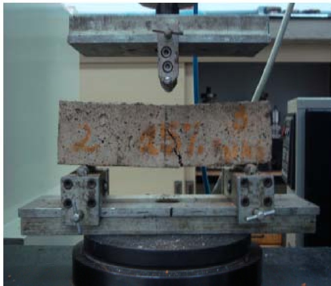
Figura 6 – Viga após cessar carga excedente
