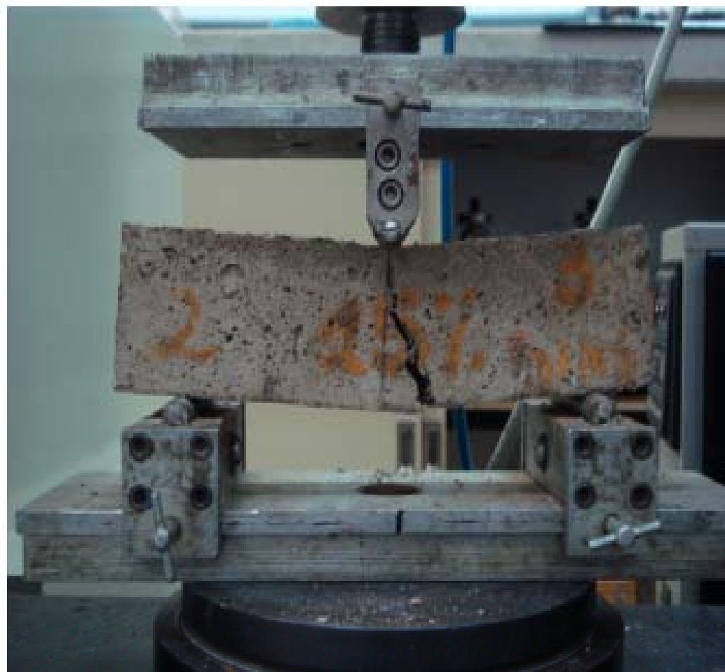
Figura 5 – Viga sob carga excedente
