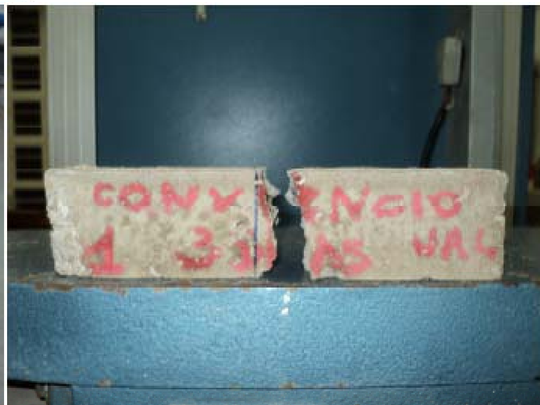
Figura 8 – Viga convencional rompida por completo
