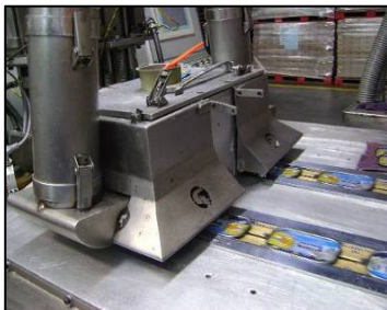
Fig. 6. Envernizamento de tampas
