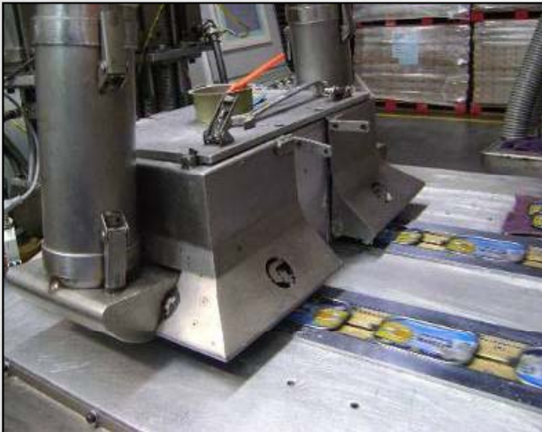
Envernizamento de tampas
