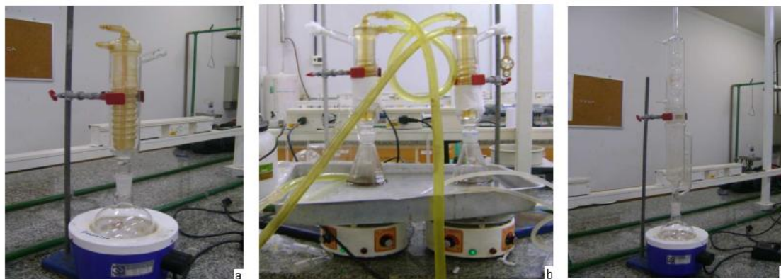
Fig. 2. a) Método direto sem agitação; b) Método direto com agitação; c) Método indireto (Soxhlet).
