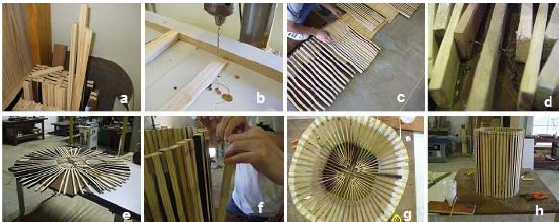
Figura. Etapas de fabricação do cesto: a) seleção dos resíduos e organização; b) furação das peças; c) posicionamento das peças para a amarração; d) amarração da base com arame; e) montagem na bancada; f) amarração do corpo do cesto; g) vista superior do cesto; h) vista frontal do cesto.
